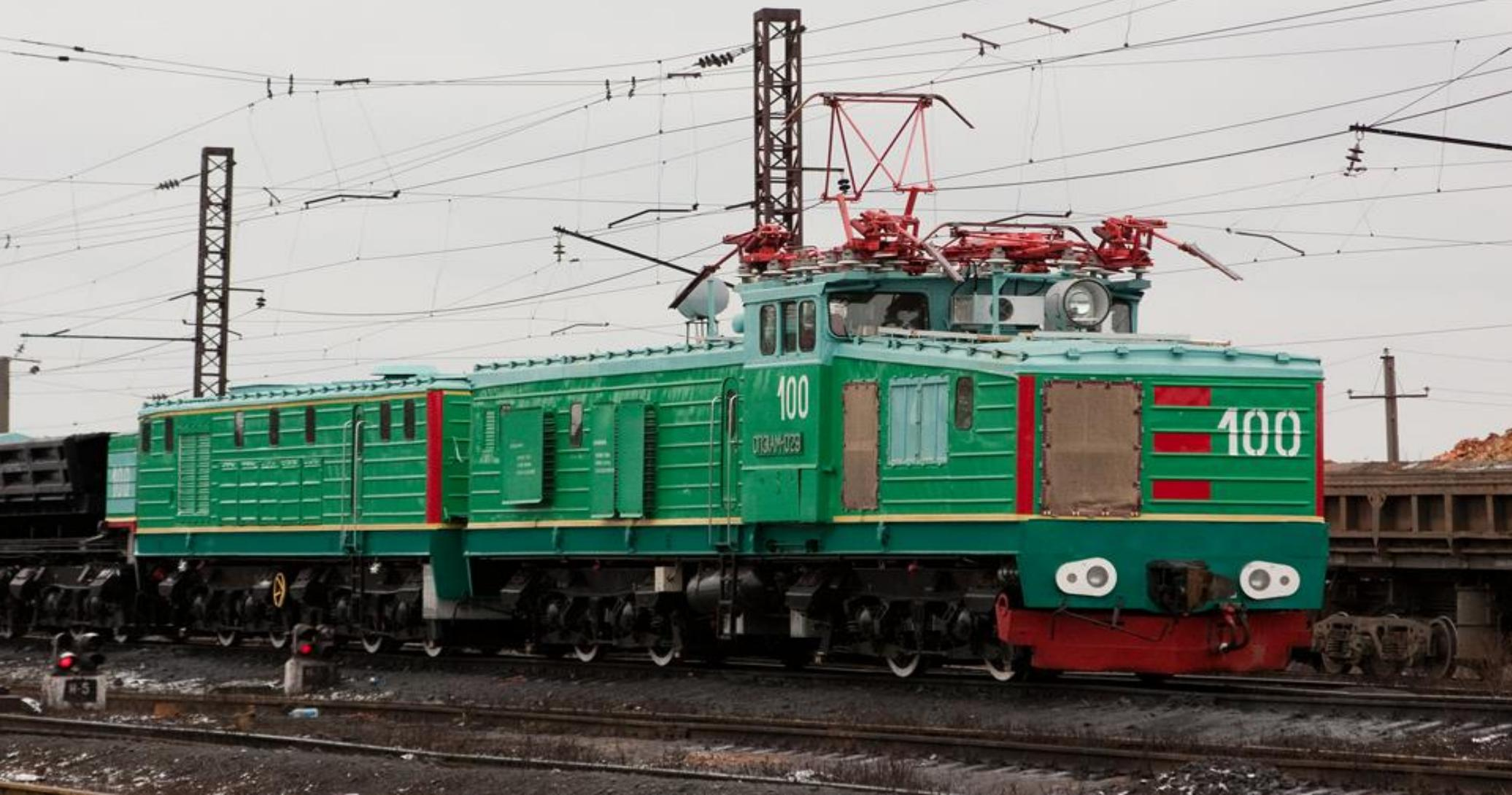
**ОПЭ1АМ** (Однофазный, Промышленный Электровоз, с 1 (одним) моторным думпкаром, Автономный Модернизированный) — тяговый агрегат, состоящий из промышленного электровоза, дизельной секции автономного питания и одного моторного думпкара
