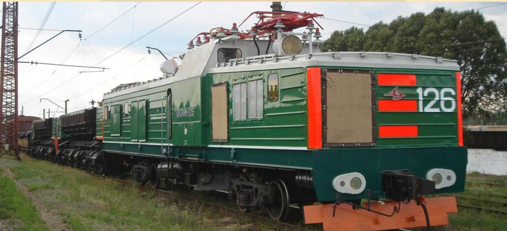
Тяговые агрегаты ОПЭ1А выпускались Днепропетровским электровозостроительным заводом с 1973 по 1988 годы; начиная с 1988 года по настоящее время завод выпускает модернизированную версию ОПЭ1АМ. Конструкция данной модели предусматривает использование дизельного тягового агрегата и работу от контактной сети. На данный момент все модели данного типа на СевГОК работают от контактной сети.
